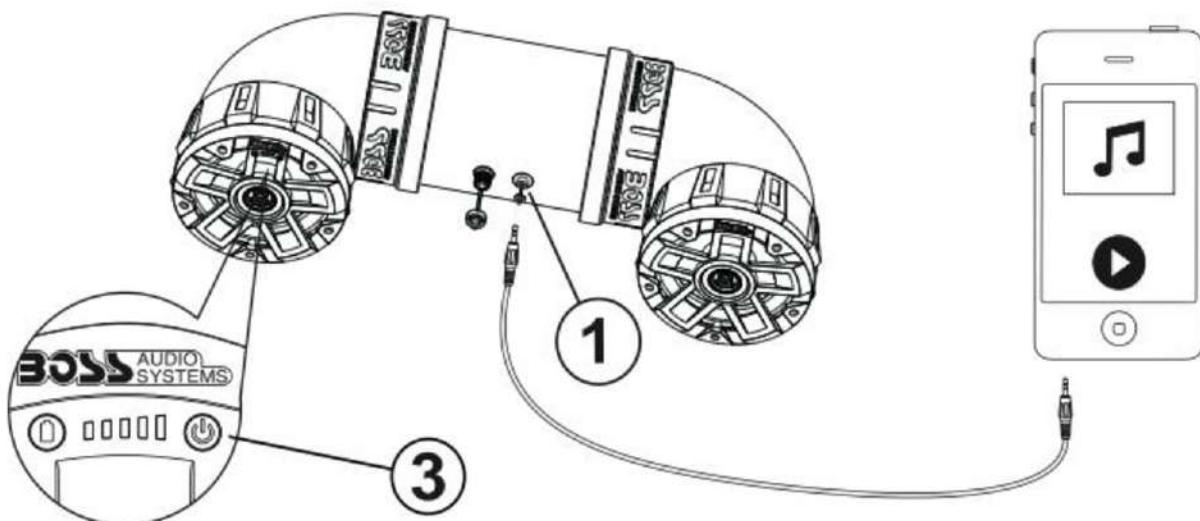
**ATV6.5R** может воспроизводить звук с любого устройства, имеющего аудиоразъем для наушников 3,5 мм.
