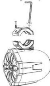
Используя шестигранный ключ на 3/16 дюйма, снимите верхние зажимные болты и обратите внимание на предупреждающие надписи для установки крутящего момента соединения позже.
