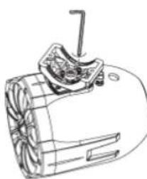
Нанесите на винты герметик для резьбы. Затяните винты с помощью шестигранного торцевого ключа на 5/32 дюйма и динамометрического ключа до 44 дюймов / фунт (5 нМ).
