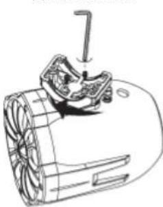
Если изменение положения динамика не требуется, открутите винты и нанесите герметик для фиксации резьбы. Используя головку с шестигранной головкой 5/32 дюйма, затяните поворотные винты с моментом 44 дюйма / фунт (5 нМ).
