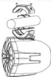
Используя подходящие резиновые прокладки (с маркировкой для внешнего диаметра) установите на верхнюю и нижнюю половину зажимов. Нанесите на болты герметик для резьбы. Равномерно затяните болты вручную (с обеих сторон должно быть одинаковое расстояние между болтами). Используя головку с шестигранной головкой 3/16 дюйма, установите динамометрический ключ на 65 дюймов / фунт (7 нМ).
