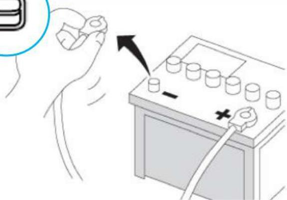
Во избежание возможных коротких замыканий в электрической системе обязательно отключите (-) кабель аккумулятора перед установкой. Используйте это устройство только с 12-вольтовой батареей и отрицательным заземлением. Несоблюдение этого условия может привести к возгоранию или неисправности.
